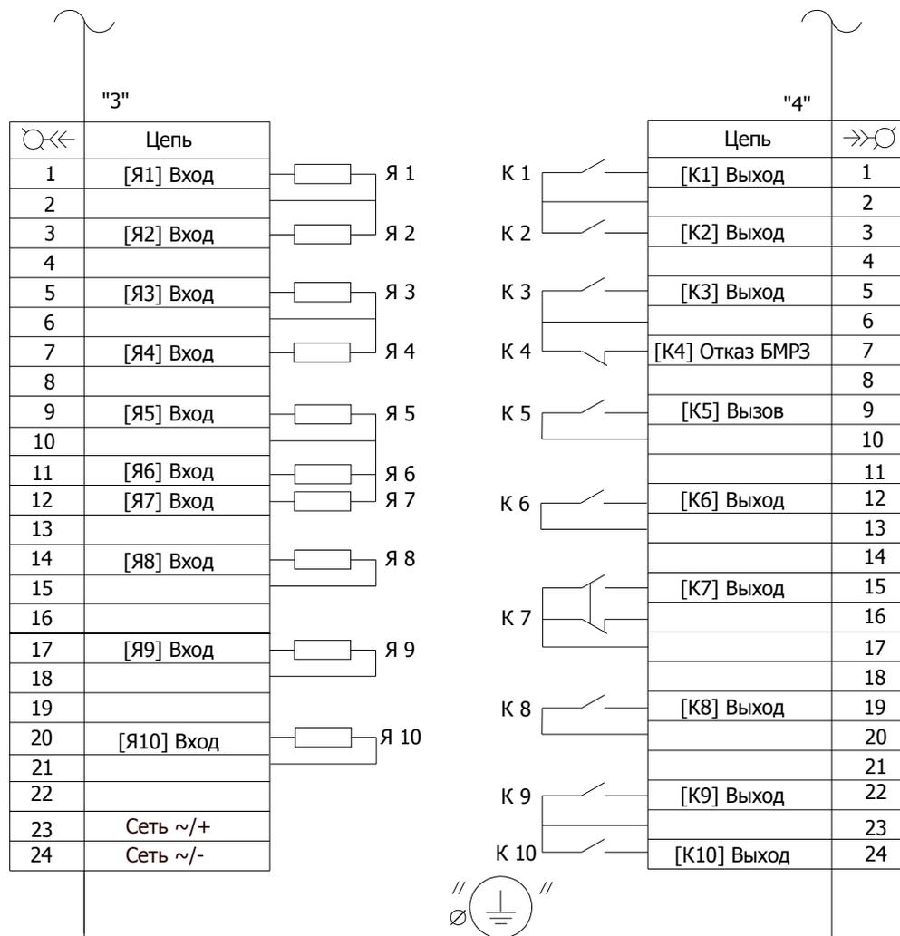
Рисунок А.2 - Схема электрическая подключения БФПО
