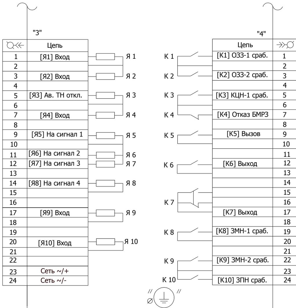
Рисунок А.3 - Схема электрическая подключения, пример ПКМ
