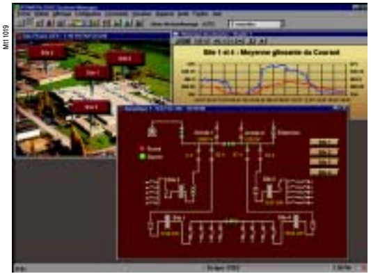
Контроль электрической сети, оборудованной Seram, при помощи программного обеспечения SMS PowerLogic System
