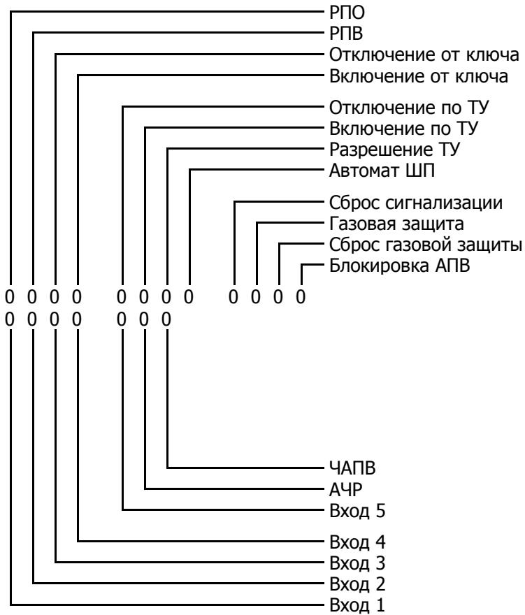
Рисунок В.1 – Соответствие входных дискретных сигналов в разделе «Контроль».
