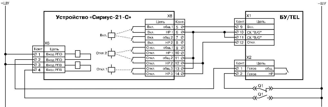
Рисунок Д.3 – Схема подключения устройства «Сириус-21-С»
