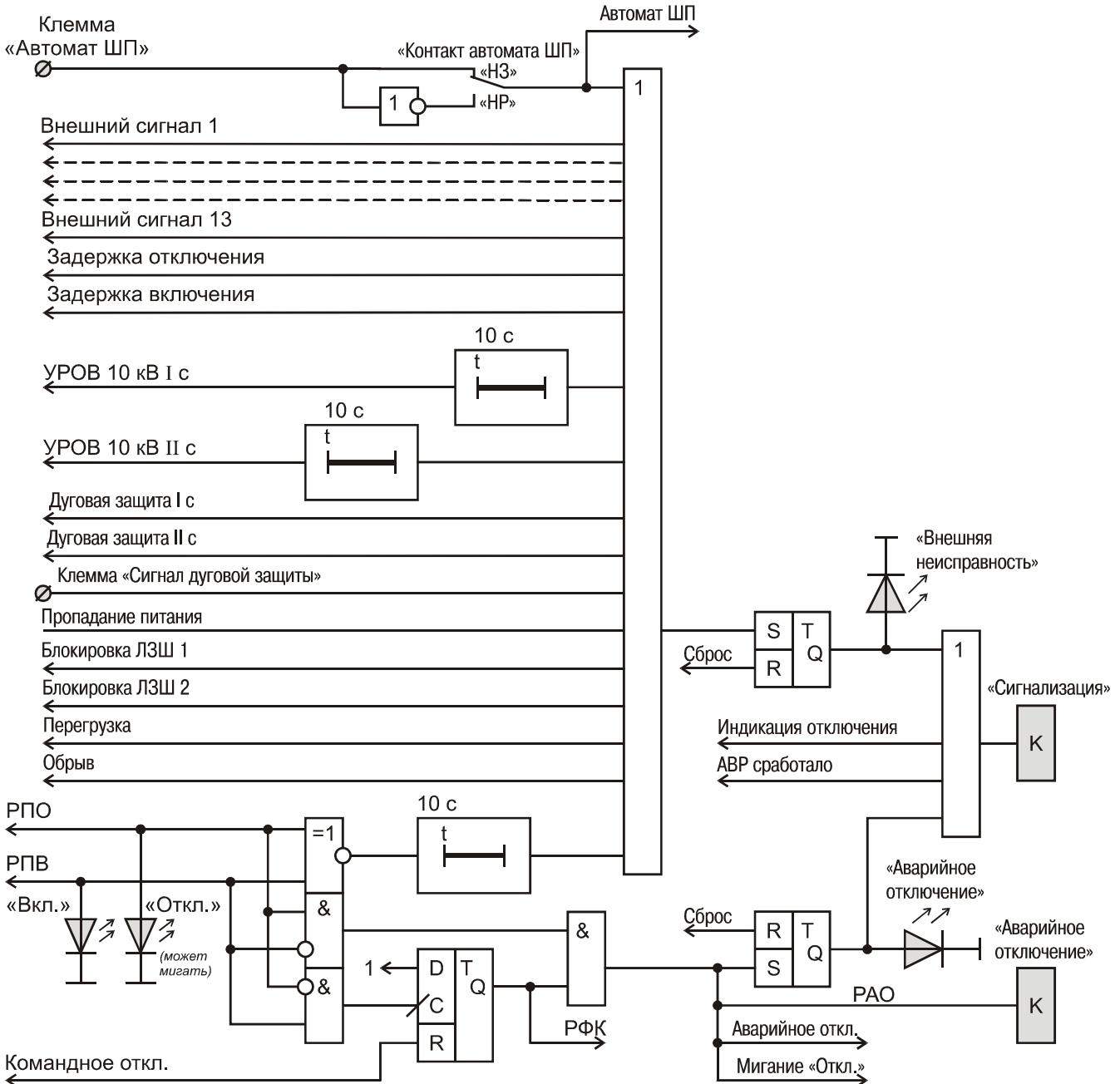
Рисунок И.2 – Цепи аварийной и предупредительной сигнализации
