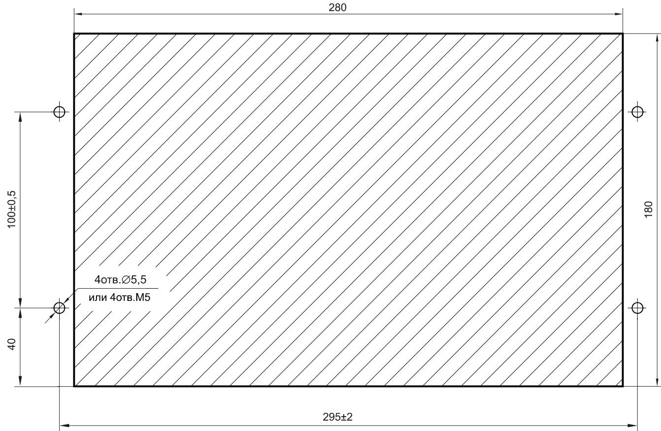
Рисунок Г.4 – Разметка панели под установку устройства
