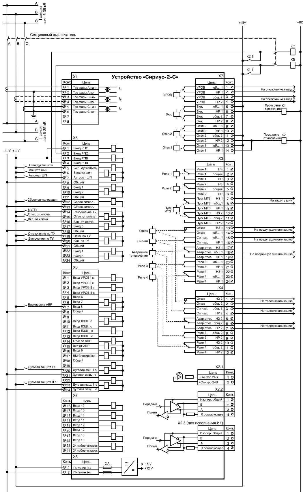
Рисунок Д.1 – Схема подключения внешних цепей к устройству «Сириус-2-С»
