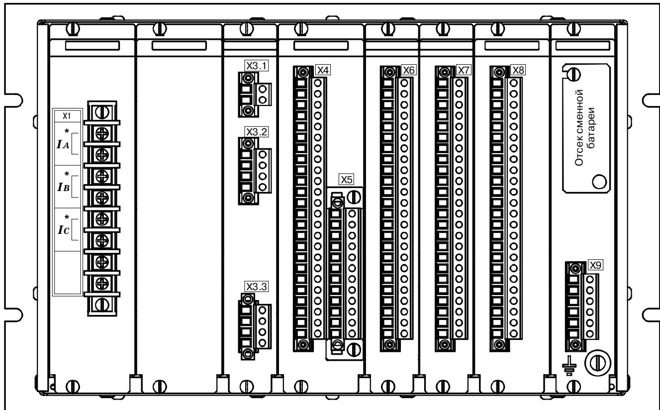
Рисунок Г.6 – Расположение элементов на задней панели устройства «Сириус-21-С»
