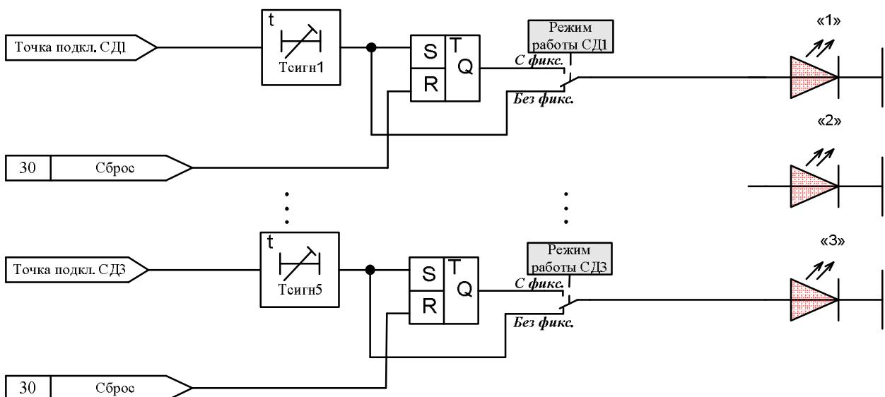
Рисунок И.27 – Программируемые светодиоды
