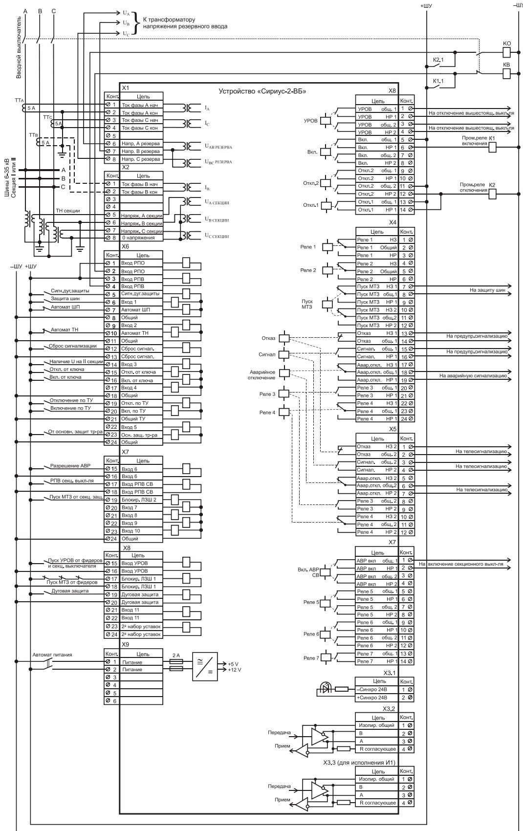
Рисунок Д.1 – Схема подключения внешних цепей к устройству «Сириус-2-ВБ»
