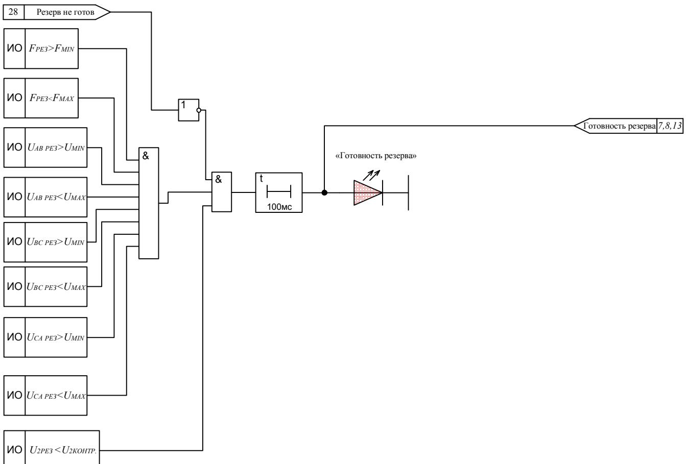
Рисунок И.21 – Формирование признака «Готовность резервного источника»
