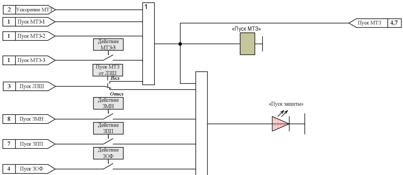
Рисунок И.6 – Реле «Пуск МТЗ» и светодиод «Пуск защиты»
