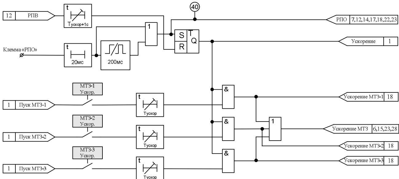
**Рисунок И.2 – Ускорение МТЗ**
