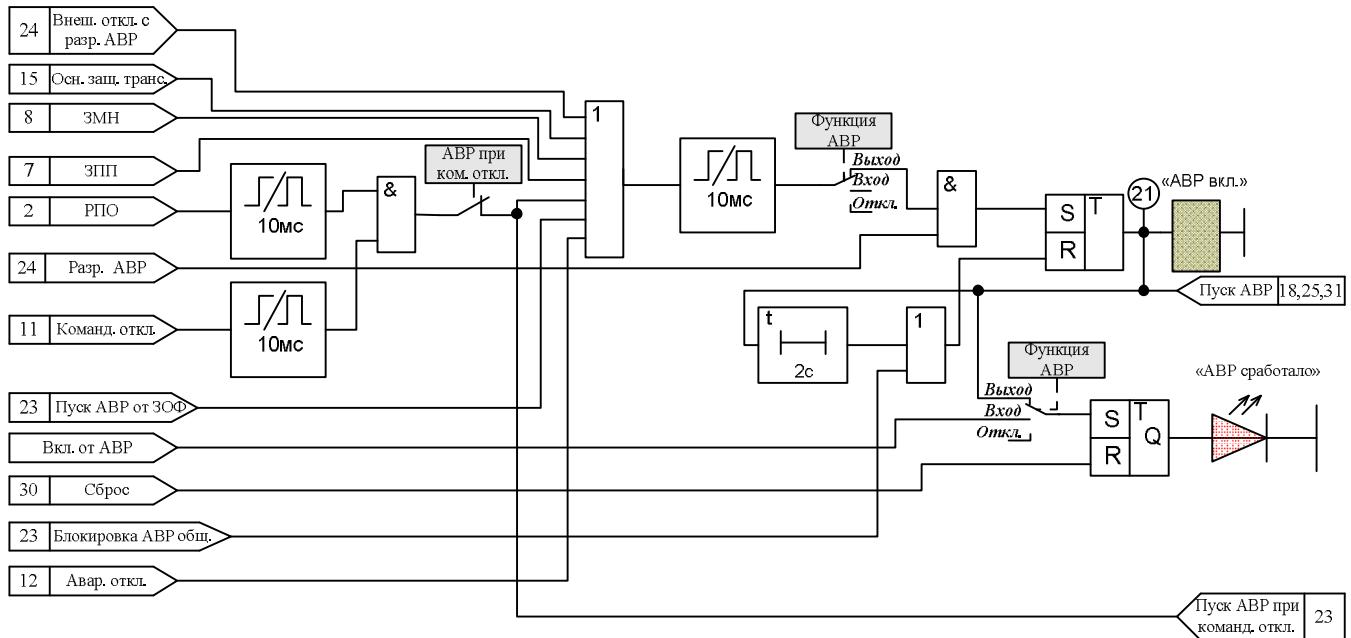
Рисунок И.22 – Автоматическое включение резерва (АВР) (начало)
