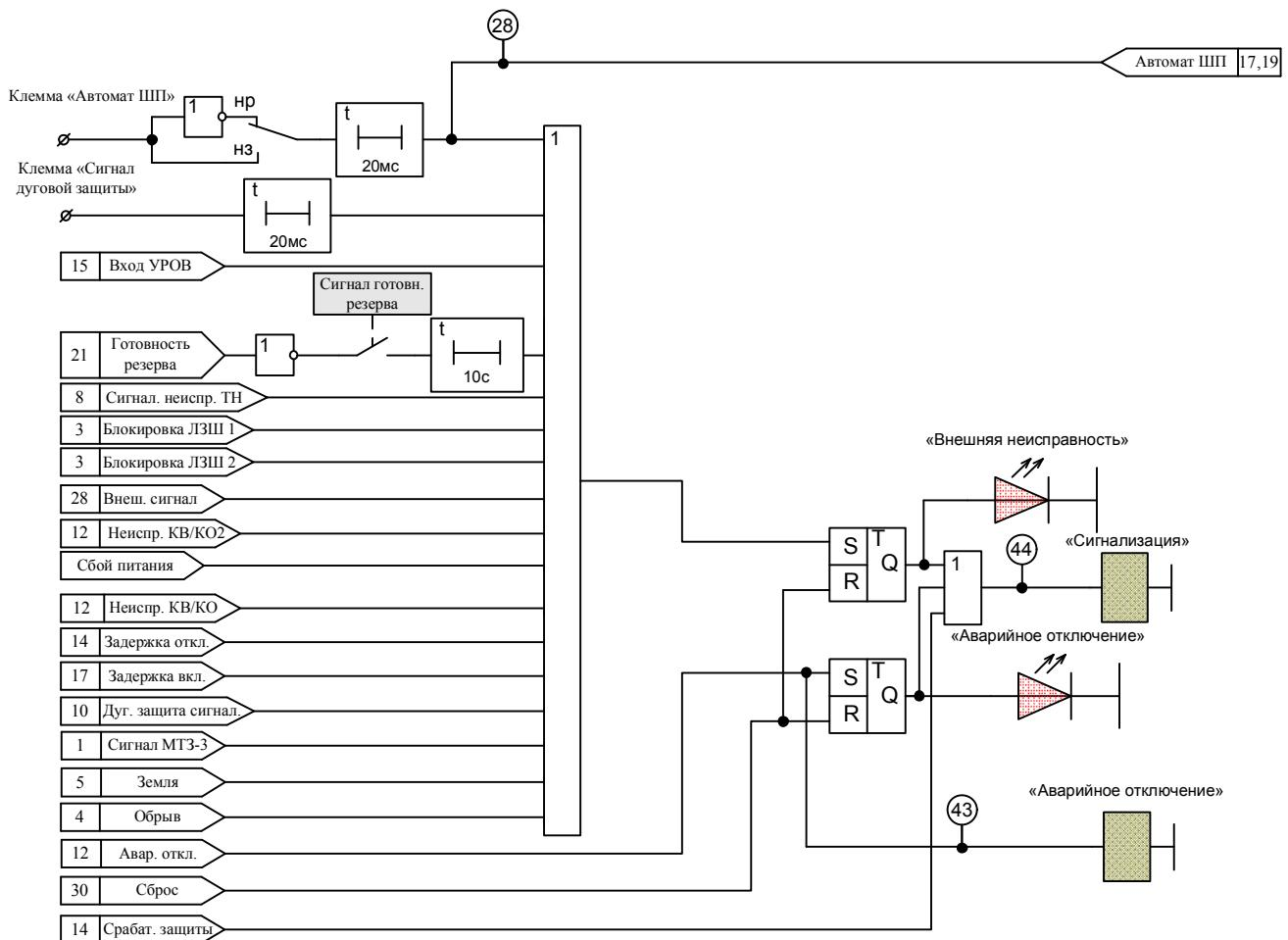
Рисунок И.13 – Аварийная и предупредительная сигнализация
