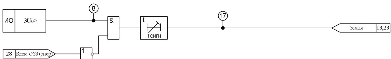
Рисунок И.5 – Сигнализация однофазного замыкания на землю
