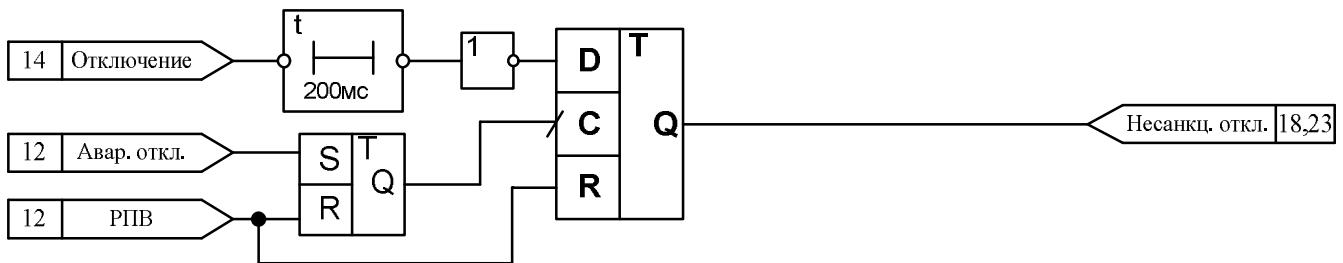
Рисунок И.20 – Формирование признака «Несанкционированное отключение»
