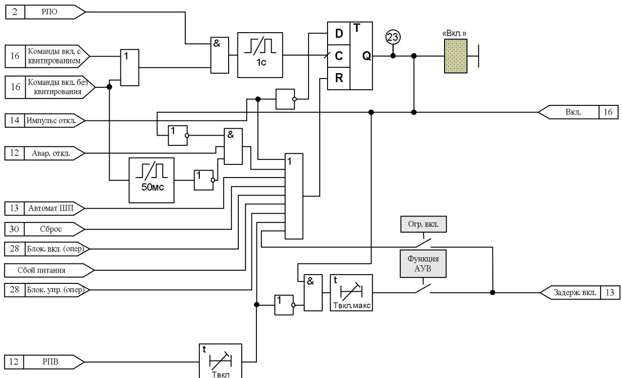
Рисунок И.17 – Автоматика управления выключателем – включение (окончание)
