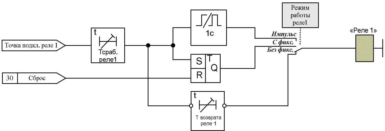
Рисунок И.26 – Программируемые реле
