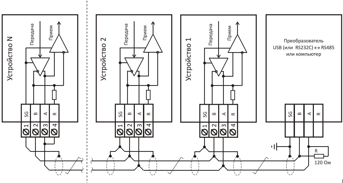
Рисунок Д.5 – Схема подключения устройств с интерфейсом RS485 в локальную сеть.
