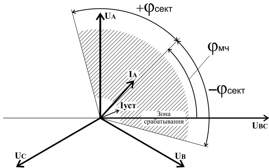
Рисунок 1 – Поясняющая диаграмма определения направления мощности
