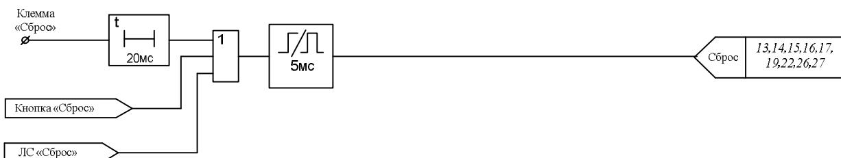
Рисунок И.30 – Сброс сигнализации
