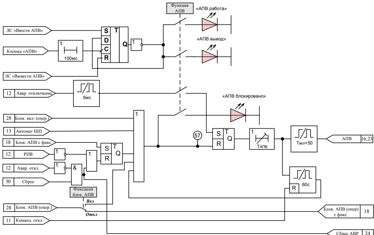
Рисунок И.19 – Автоматическое повторное включение (АПВ)
