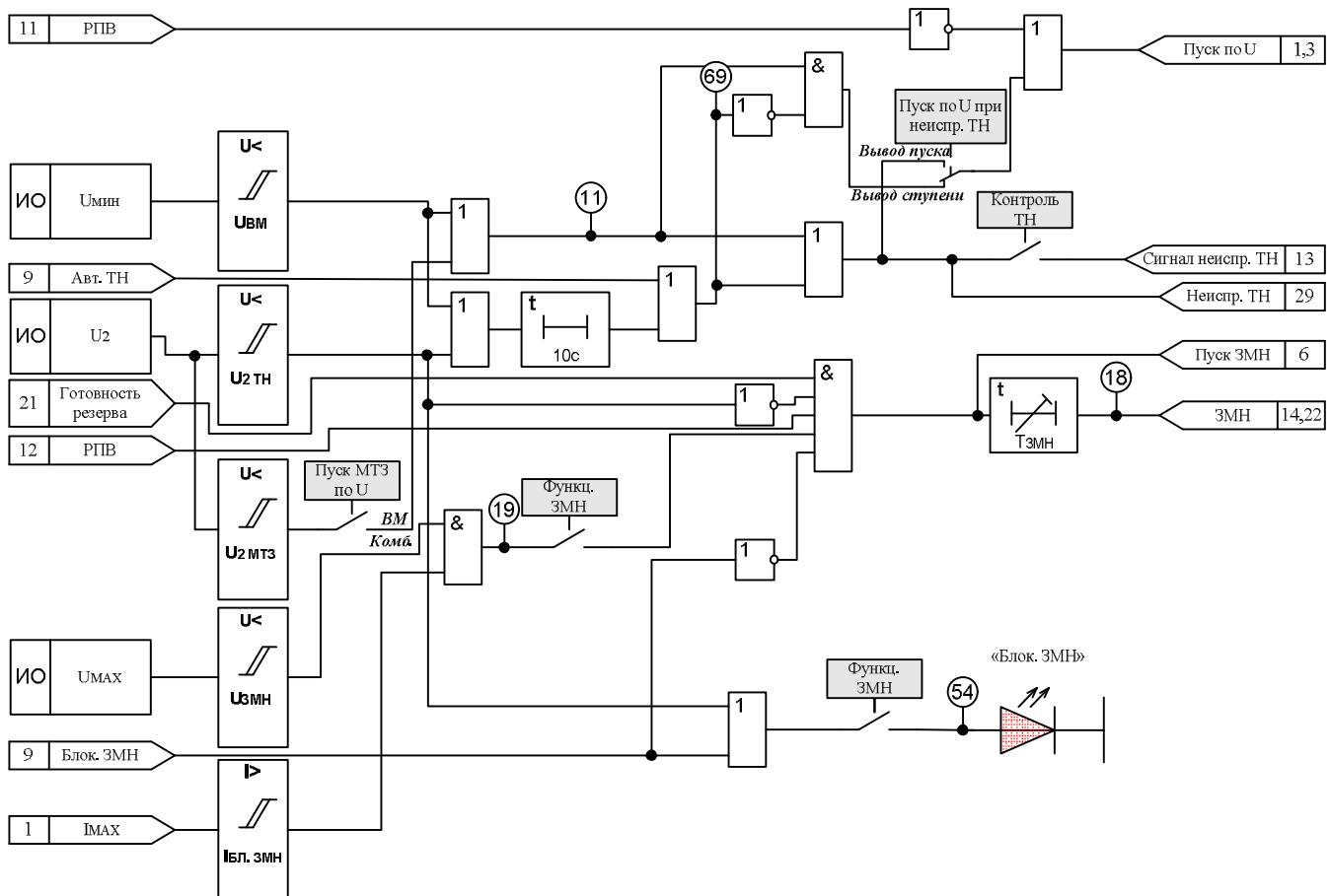
Рисунок И.8 – Защита минимального напряжения (ЗМН)
