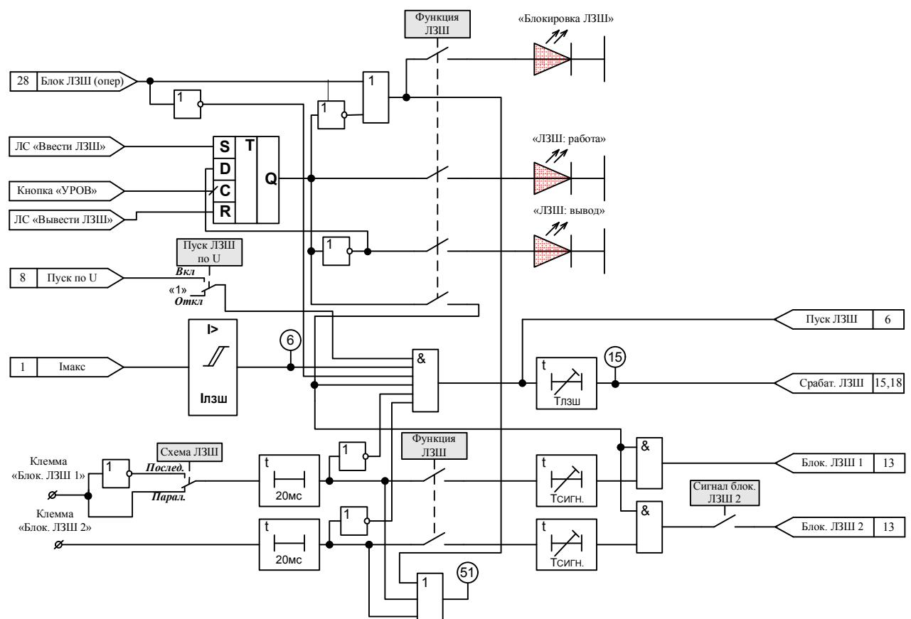
Рисунок И.3 – Логическая защита шин (ЛЗШ)
