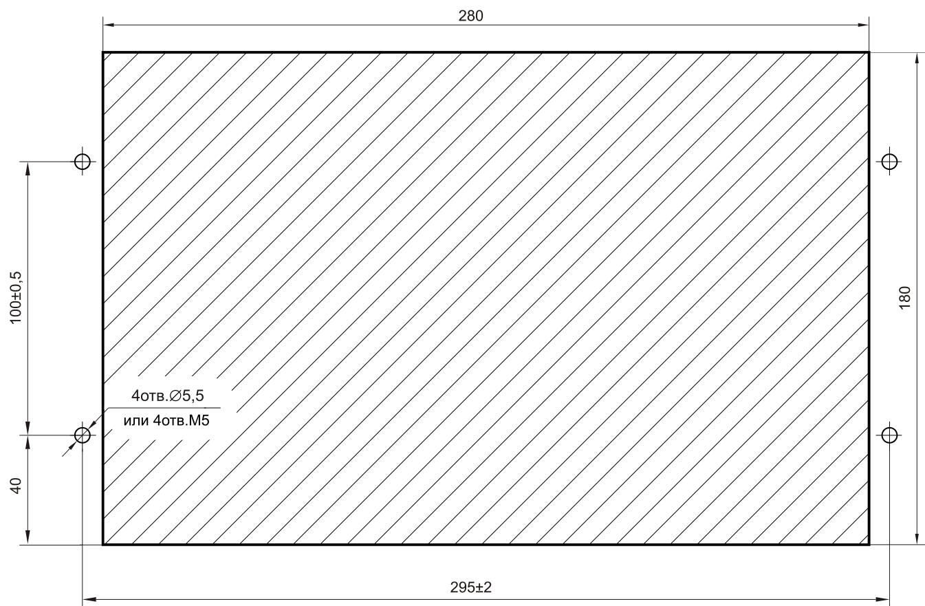
Рисунок Г.5 – Разметка панели под установку устройства
