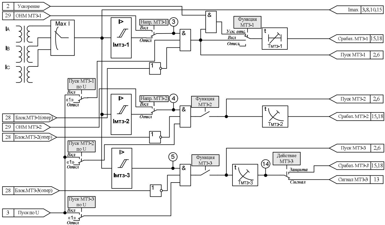
**Рисунок И.1 – Максимальная токовая защита (МТЗ)**
