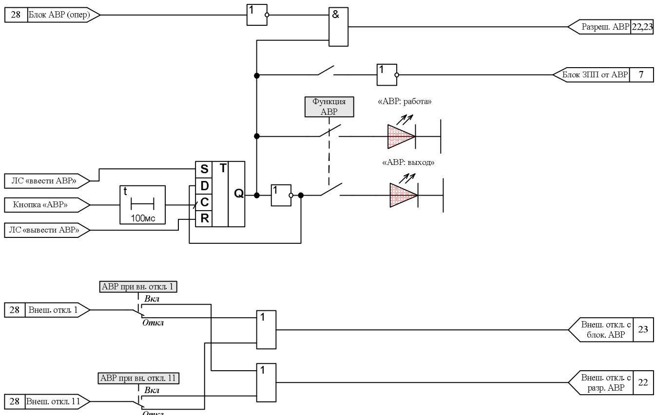
Рисунок И.24 – Автоматическое включение резерва (АВР) (окончание)
