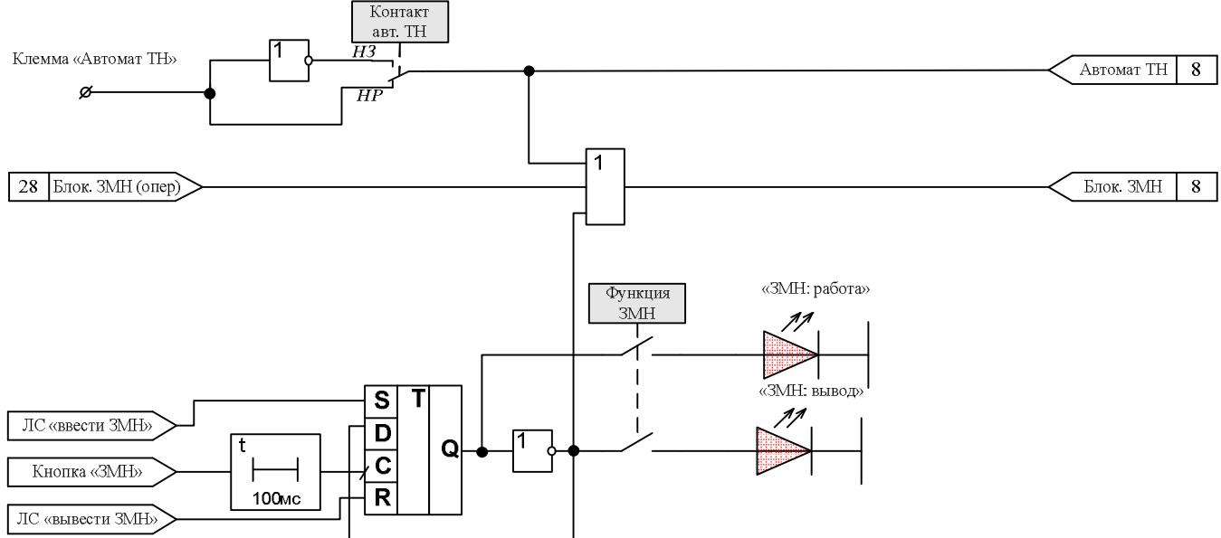
Рисунок И.9 – Защита минимального напряжения (ЗМН)
