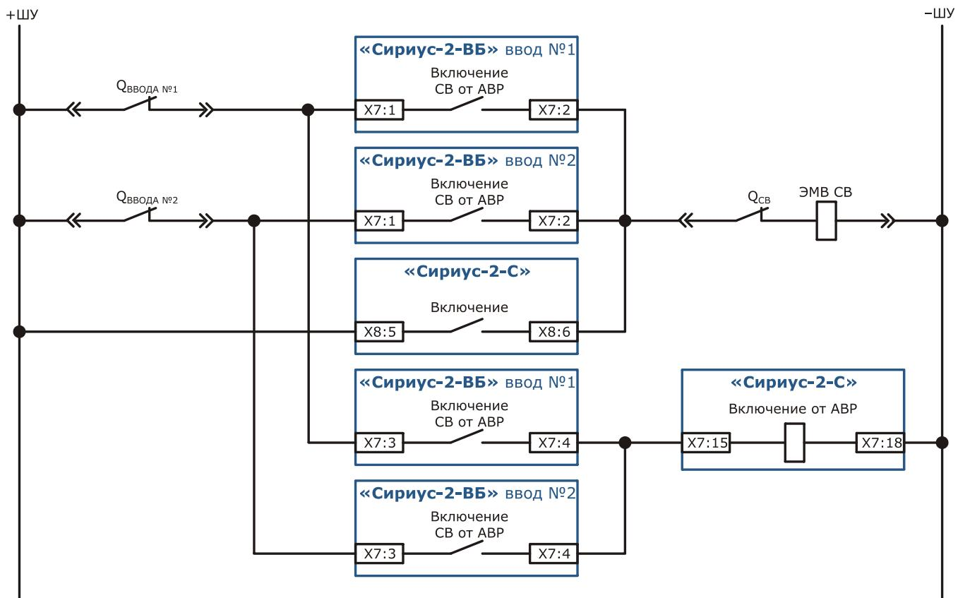
Рисунок Д.9 – Фрагмент схемы цепи включения секционного выключателя
